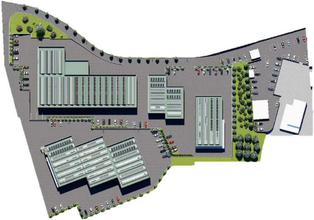
Il PA prevede la rigenerazione urbana del comparto relativo all'ambito AT17, su cui insisteva l'insediamento produttivo ex Falck abbandonato e degradato; al momento i capannoni risultano interamente demoliti e le aree bonificate o in corso di bonifica. Il progetto prevede, la costruzione di nuovi fabbricati a destinazione industriale-artigianale, la realizzazione di accessi e di aree a parcheggio, la sistemazione a verde di parte delle aree, proponendo la valorizzazione dell'intero comparto.
